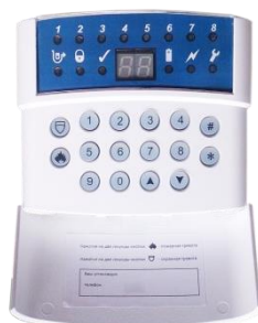
Рис. 2. Беспроводная клавиатура М4064КР
