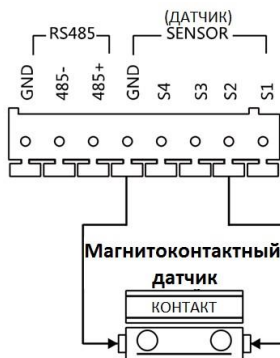
Рисунок 5-18 Подключение магнитоконтактного датчика для моделей DSKD8102-V/DS-KD8002-VM (2)
