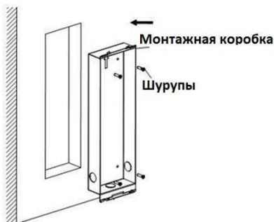
Рисунок 5-3 Установка монтажной коробки в стену
