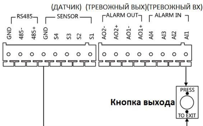
Рисунок 5-20 Подключение кнопки выхода для моделей DS-KD8102-V/DS-KD8002VM (1)
