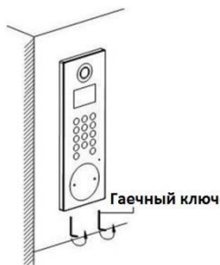
Рисунок 5-5 Затягивание винтов вызывной панели
