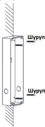
Рисунок 5-13 Установка монтажной коробки в стену
