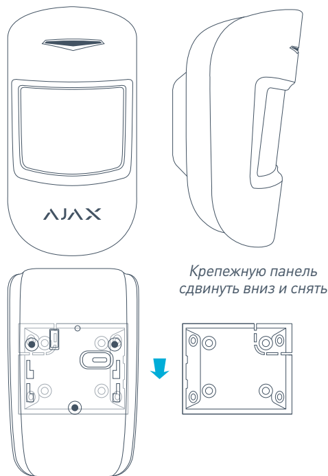
РИС. 1. Датчик движения MotionProtect Plus и его крепежная панель
