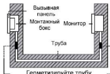
Герметизируйте трубу для предотвращения циркуляции воздуха
