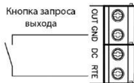
Рис.5. Подключение кнопки запроса прохода
